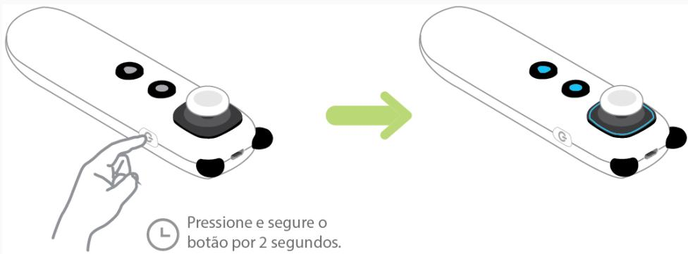
**Nota:** Mantenha pressionado o botão de energia (cerca de 2 segundos) até que todas as luzes indicadoras sejam desligadas para desligar a caneta de controlo por toque.
