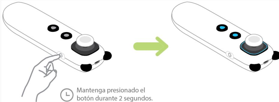
**Nota:** para apagarlo, Mantenga presionado el botón de encendido durante 2 segundos hasta que todos los indicadores estén apagados.
